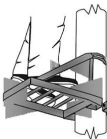
Ejemplo de accesorio: Descanso metálico con apropiados medios de sujeción para dotar de adecuado posicionamiento y seguridad al trabajador en la zona de trabajo
