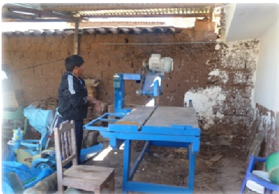
Instalación de maquinaria cortadora de piedra con motor eléctrico de 10 Hp. Producción a mediana escala que le permite mejor calidad del producto y mayor rentabilidad.
